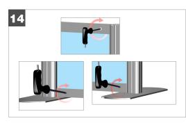
TIGHTEN REMAINING CORNER TORX SCREW
