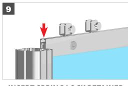
**INSERT SPRING LOCK RETAINER** INTO SUPPORT POST CHANNEL
