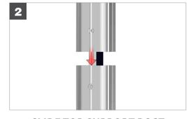
SLIDE TOP SUPPORT POST ONTO BOTTOM SUPPORT POST
